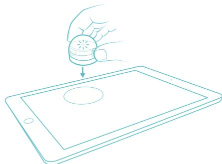
Uvolněte tlačítko a umístěte Ozobota na bílé vyhrazené místo nebo na BÍLOU část obrazovky. Ozobot začne blikat bíle.
